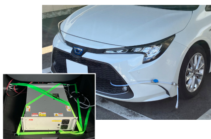
レーザー分光式検知器を搭載した自動車 (左:レーザー分光式検知器 右:ガス吸い込みチューブ)
