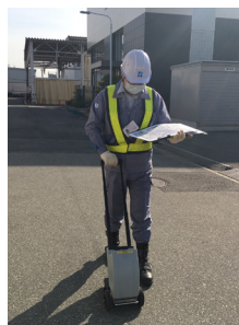
半導体式検知器による漏えい検査状況
