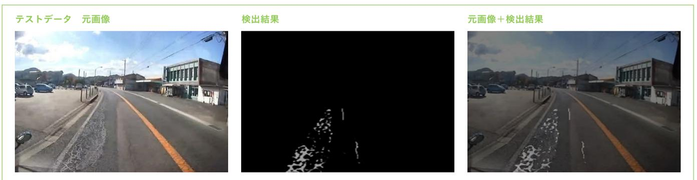
図4 舗装ひび割れのAI判定の事例
