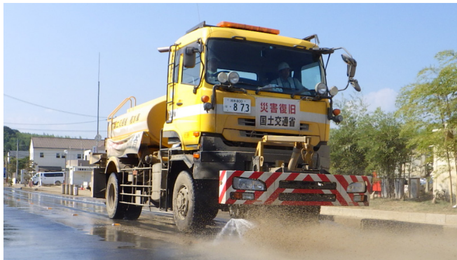
写真-7 散水車による路面清掃
