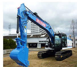
写真-2 遠隔操作式バックホウ
