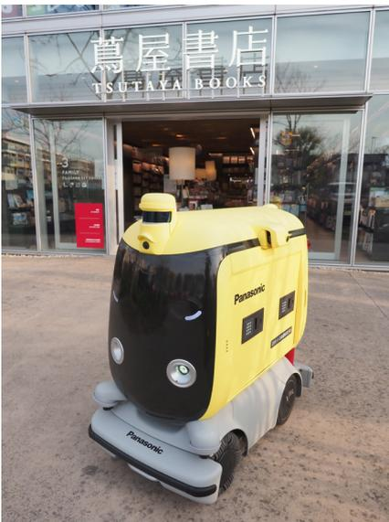
実証実験中の自動搬送ロボット(通称:ハコボ)
